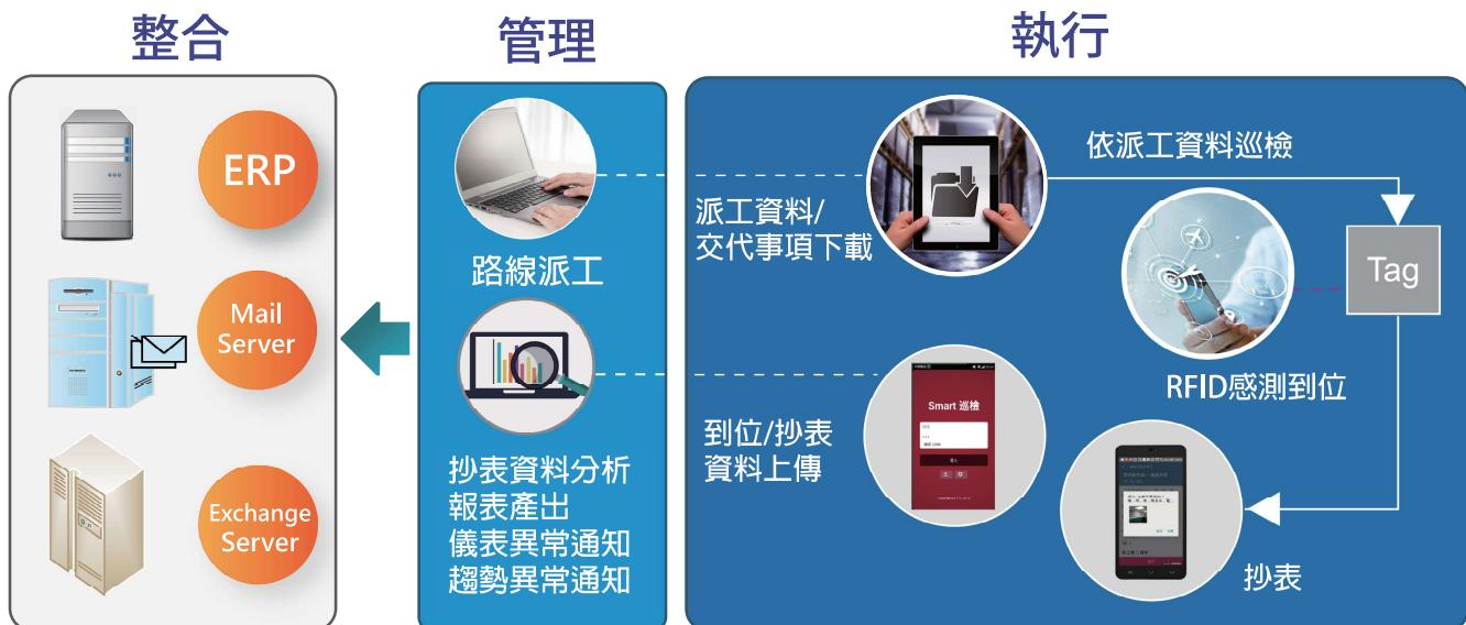
目前台塑網Smart巡檢系統已成功應用在石化業、電子業、製造業、物業、醫院、學校及公用事業等廠房巡檢、設備巡檢、製程巡檢、保養巡檢及倉儲物流等作業；目前更結合無線網路、GPS與地理資訊系統擴大應用於工業地下管線巡檢，透過整合管理IT資訊、通訊網路與行動裝置，更加提升服務品質與系統功能，智慧化行動管理亦有效幫助企業強化設備管理競爭力。
